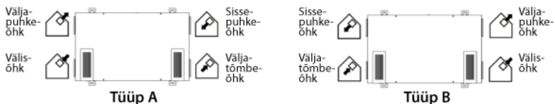
Joonis 23: Õhutorude asetus sõltuvalt konstruktsioonitüübist (tüüp A või B)
